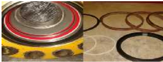
Gambar 1. Seal Kit Silinder Hidrolik Bucket PC – 2000 Sumber : Penulis
