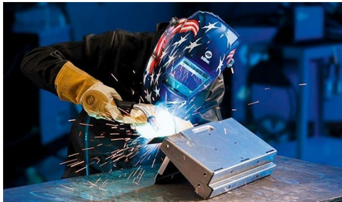
Gambar 2. Proses Pengelasan MIG ( Metal Inert Gas ).
