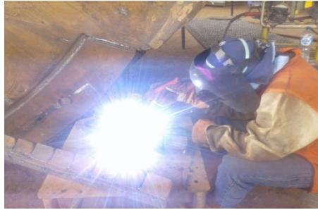
Gambar 5. Pengelasan plat yang akan diuji daya tariknya
